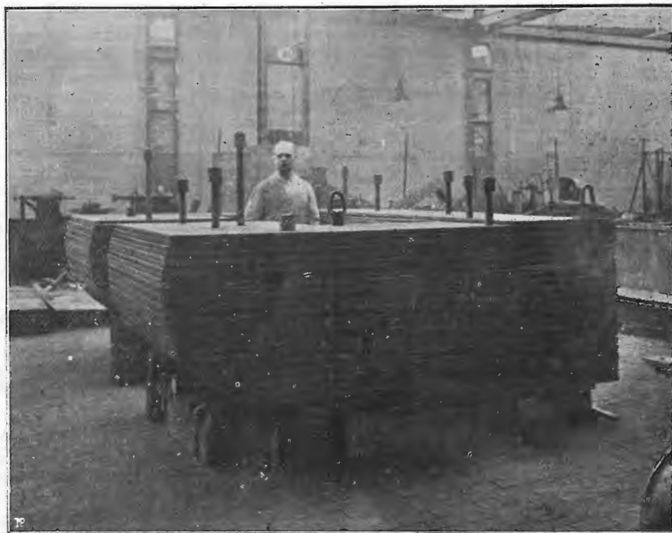
Fig. 4. - Nucleo magnetico per il trasmettitore ad arco Poulsen (1000 Kw.)
